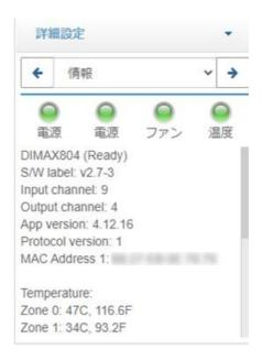
センサーが正常な変数を測定している際は、緑色のランプが表示されます。1 つもしくは複数の変数が適正な領域を超える場合、赤色のランプが表示されます。
