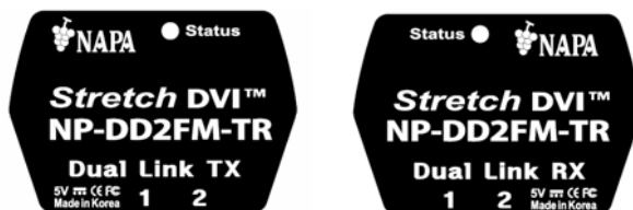
[図 2] ラベル上のファイバー番号およびステータス LED の位置
