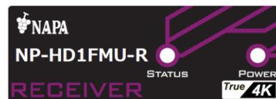
注) 電源が供給されると、Power LED が点灯し、接続が確立すると Status LED が点滅します。
