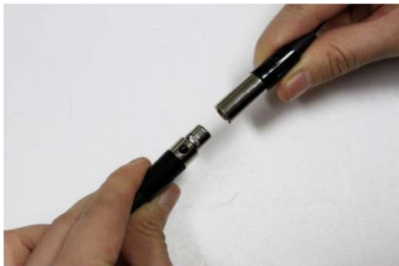
[図 3] 送信モジュールの AC アダプタ接続
