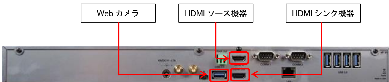
[図 1.2] ソース機器とシンク機器を接続した時の接続例
